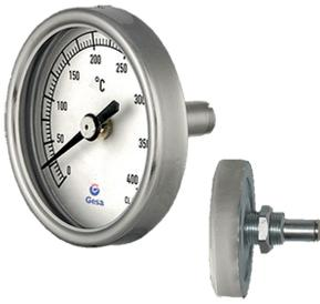
Besonders für Türereinbau in Öfen oder Eisenöfen geeignet. Das Thermometer enthält kein Schutzrohr. Einfach zu installieren, wird ein Loch mit ausreichendem Durchmesser benötigt, um den Schaft durch die Tür einzuführen, dann sollte der Sensor durch einen Gewindering an dem Schaft fixiert werden. Kontakt mit Feuer vermeiden.
